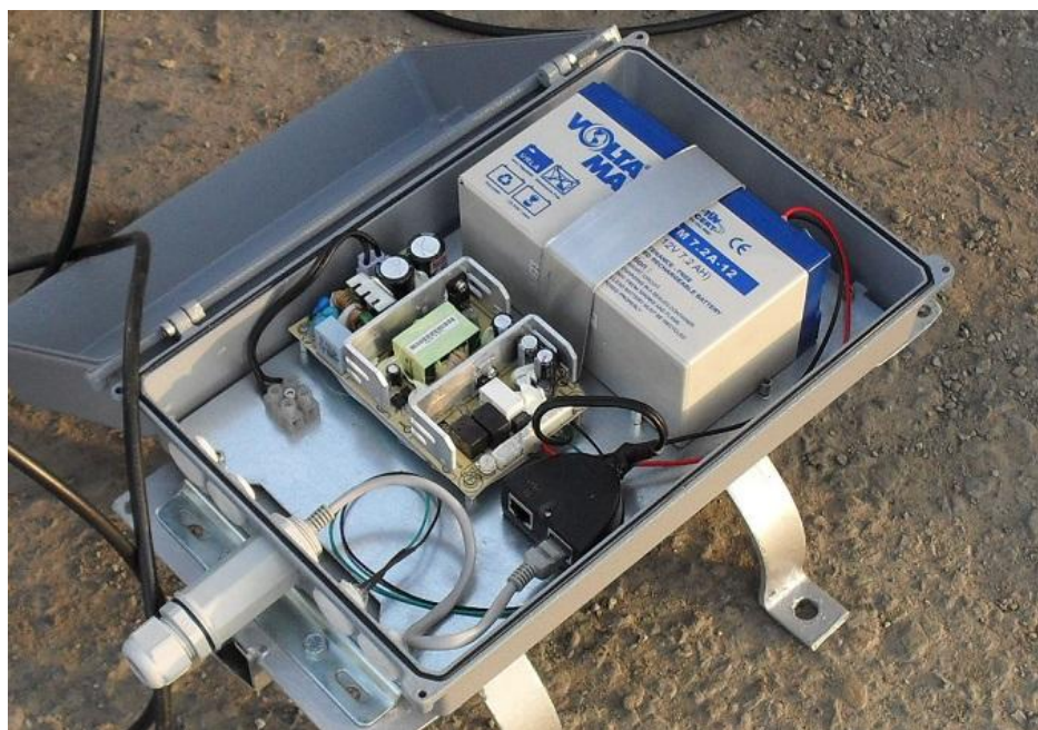
تصویر ۷ - ترکیب‌بندی اجزاء منبع تغذیه RSU در محل‌هایی که امکان استفاده از برق شبانه وجود دارد.
