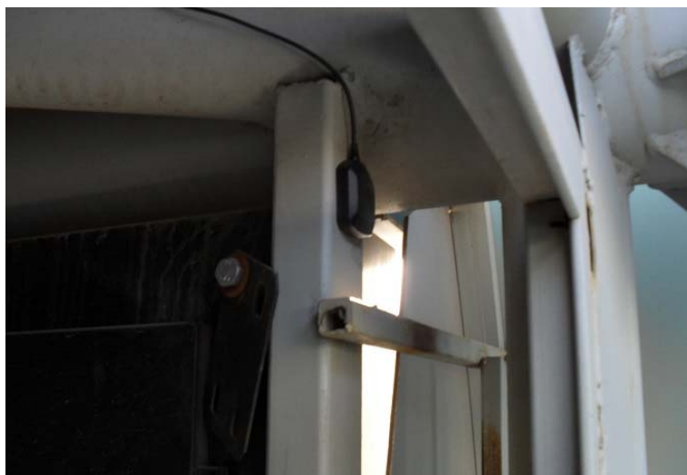
شکل ۵ - نصب آنتن GPS در خارج از محفظه RSU
