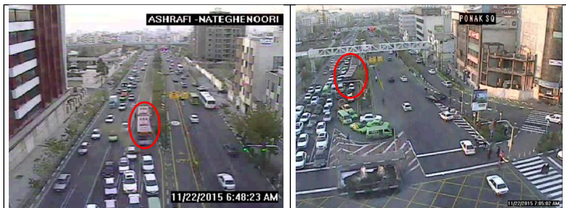
شکل ۳: یکی شدن مسیر حرکت خودروها با خط ویژه اتوبوس در تقاطع‌های پونک و ناطق نوری (به سمت شمال)
