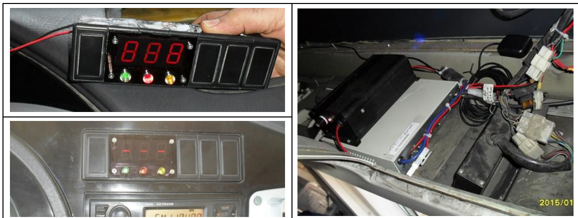
شکل ۲: (سمت راست) نصب تجهیزات OBU و (سمت چپ) نصب پنل اعلام وضعیت به راننده در داخل اتوبوس
